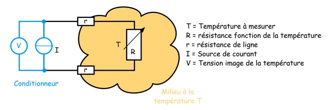
Dans le montage précédent, la tension V dépend aussi des résistances de ligne r. Pour éviter cela, on ajoute deux fils aux bornes de la résistance, on utilise alors une résistance avec quatre fils.
