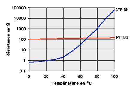
Un second avantage des thermistances est leur faible encombrement. On les fabrique sous forme de petits cylindres (d = 1 à 12 mm, L = 5 à 50 mm) de disques, de perles. La variation de résistance des thermistances dépend des matériaux utilisés. Leur domaine d'utilisation va de -80°C à +700°C avec une précision de 0,1 à 0,5 °C. Les thermistances ne présentent pas le phénomène de polarisation et peuvent être traversées indifféremment par un courant continu ou alternatif.
