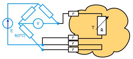
T = température à mesurer R = résistance fonction de la température
