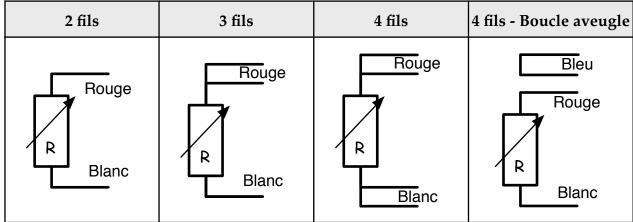
La recherche d'une bonne sensibilité de mesure conduit à faire traverser la résistance par un courant relativement important. Cependant, celui-ci risque alors de provoquer par effet Joule un échauffement du capteur qui peut cesser d'être négligeable et qui en tous cas doit pouvoir être estimé et minimisé : c'est pourquoi les courants de mesure sont généralement de l'ordre du mA et rarement supérieurs à 10 mA.
