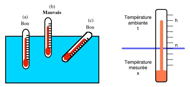
Dans le cas (b) la colonne de liquide est immergée jusqu'à la graduation n, dans l'enceinte de température inconnue. La partie de la colonne située entre n et h est en contact avec la température ambiante. Le volume correspondant à une graduation est noté v.
