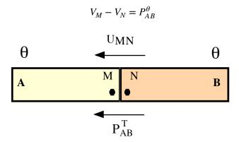
La loi de Volta nous dit que dans un circuit isotherme, constitué de conducteurs différents, la somme des f.e.m. de Peltier est nulle. On a donc :
