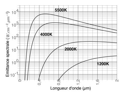
Sur la figure ci-dessus, on remarque l'augmentation rapide de l'émittance avec la température et le déplacement du spectre de l'infrarouge vers le visible (de  $0,4~\mu m$  à  $0,8~\mu m$ ) au fur et à mesure que la température augmente.
