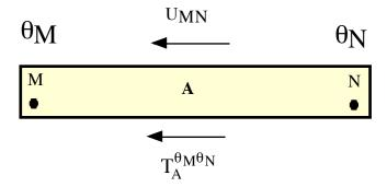
Soit un circuit fermé, constitué de deux conducteurs A et B dont les jonctions sont à des températures  $\theta_1$  et  $\theta_2$ . Ce circuit constitue un couple thermoélectrique. Ce couple est le siège d'une force électromotrice dite de Seebeck qui résulte des effets de Peltier et de Thomson qui s'y produisent.
