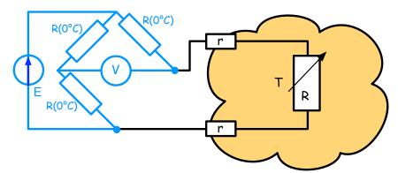
T = température à mesurer R = résistance fonction de la température
