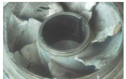
Effets de la cavitation dans une pompe
